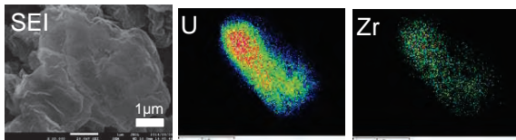
2号機オペフロ養生シート上のU含有粒子 SEM/WDSによる、SEI（二次電子像）、元素マッピング（U,Zr）
